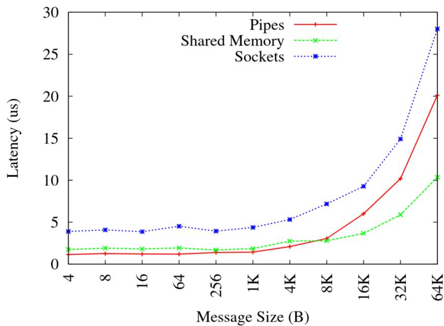
Figura 4.7: Latencia vs. Tamaño de Mensaje [101].
