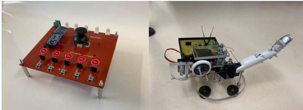
Figura.3.12 PCB y prototipo “single finger 1” accionado por servomotor
