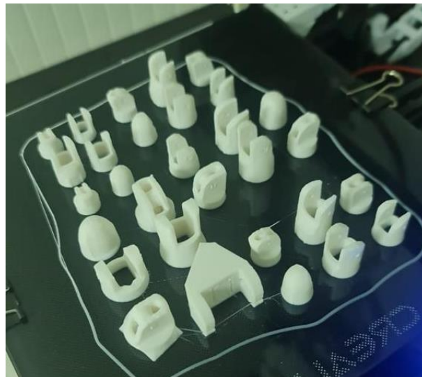
Figura.B.4 Final de la impresión de las falanges con la impresora Ender 3 pro
