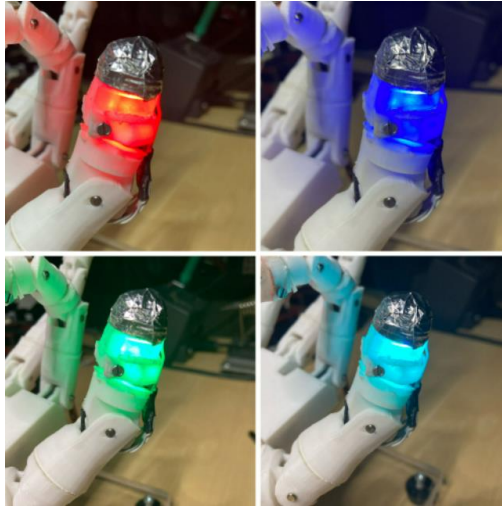
Figura.3.33 Led RGB instalado en el interior de la yema del dedo pulgar
