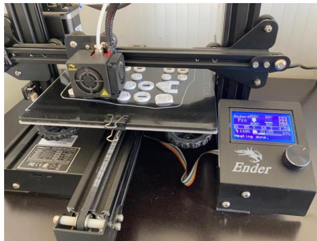
Figura.B.3 Inicio de la impresión de las falanges con la impresora Ender 3 pro
