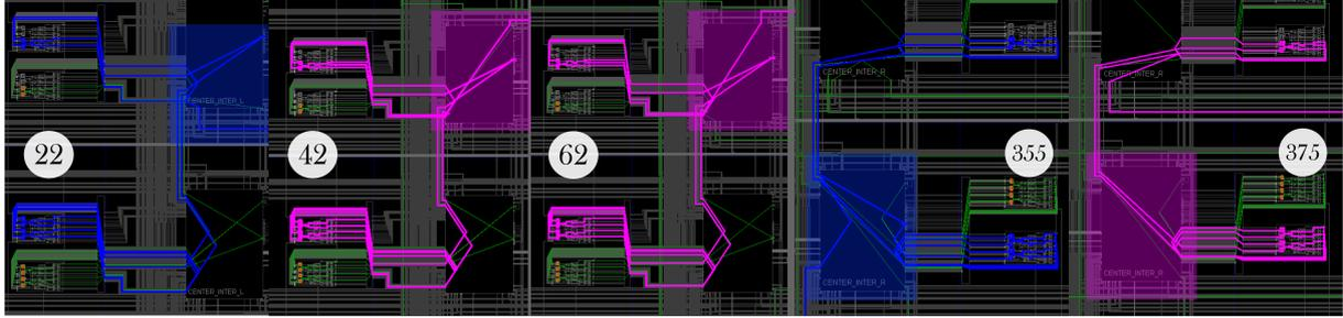
**Figura 5.3:** Diferencias entre las conexiones de los osciladores con una frecuencia inferior 42, 62 y 375 (rosa) y los osciladores adyacentes 22 y 355 (azul).
