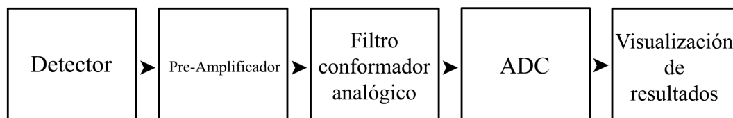
Figura 3: Esquema de un sistema de procesamiento analógico de pulsos.
