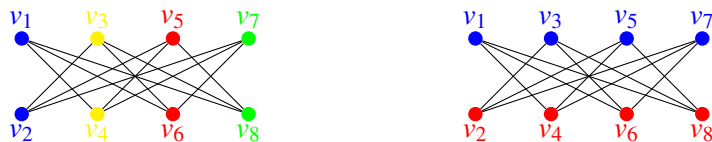
Figura 2.1: Ejemplo de la importancia de una buena ordenación en el algoritmo voraz.
