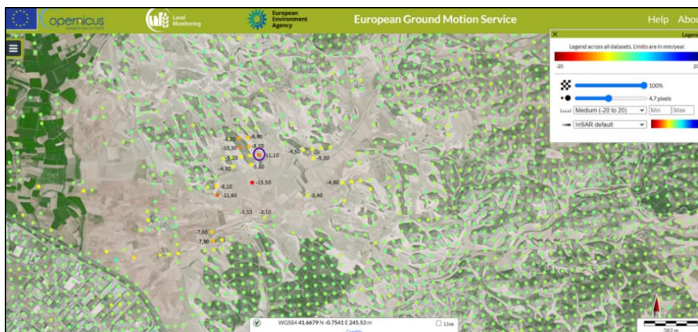
Figura 16. Datos de las tasas de subsidencia obtenidos de la EGMS mediante el análisis interferométrico multitemporal de imágenes de radar Sentinel-1 a máxima resolución con precisión milimétrica. El punto marcado con un círculo morado es la dolina de sufusión.
