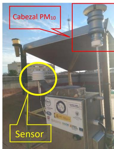
**Fig. 1:** Captador del material particulado.
