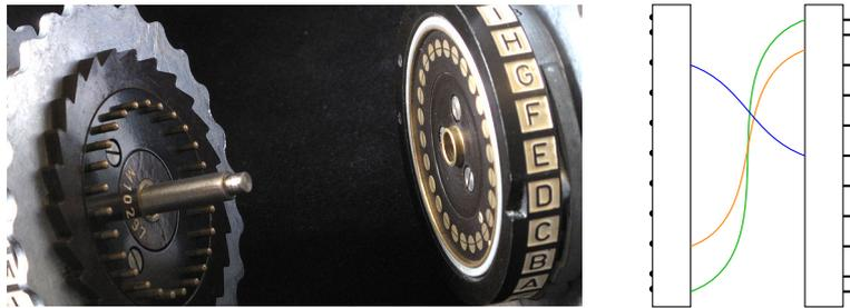
Figura 1.2: Rotor junto a diagrama simplificado del cableado similar al de [5] (Fuente de la imagen de la izquierda [6])
