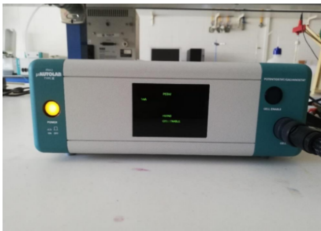
Figura 23. Potenciostato Metrohm (Eco-Chemie) \mu Autolab III, utilizado para medidas de voltametría cíclica e impulsional. Incluye un analizador de frecuencias FRA2 para medidas de impedancia electroquímica en frecuencias comprendidas entre 10 kHz y 10 \mu Hz. Incertidumbres en la medida de potencial \pm 0,1 mV y de la corriente \pm 0,1 nA.
