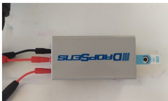
Figura 24. Potenciostato unido a la interfase de conexión de electrodos serigrafados SPCEs DropSens DSC.
