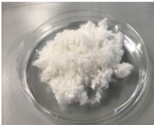
Figura 4: Pulpa de papel de filtro después de la segunda trituración.
