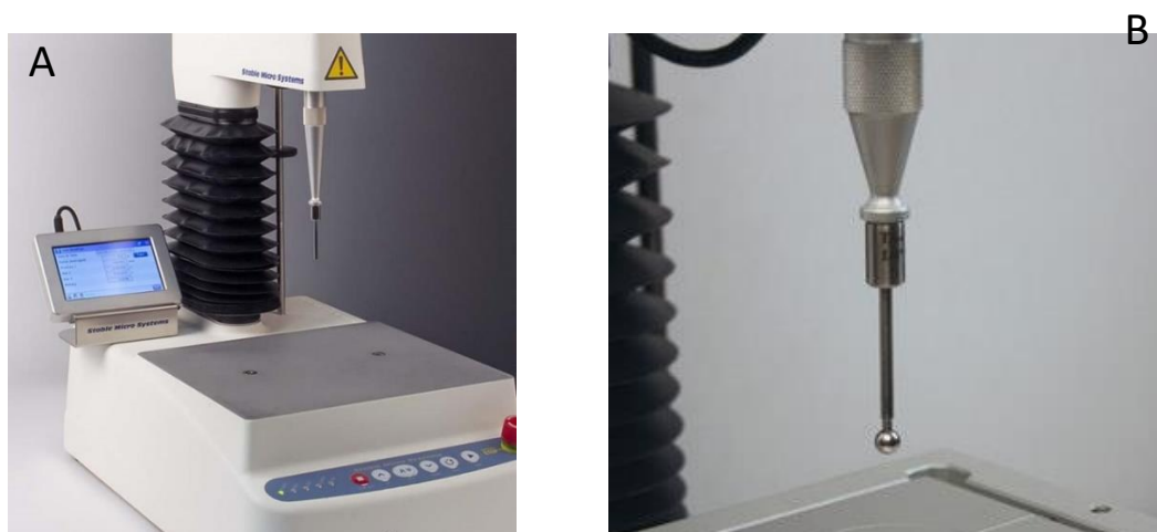
Figura 5: Texturómetro TA.XT2i (A) y sonda de punción TA-8 (B).
