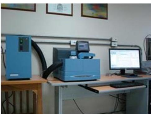
El equipo utilizado en la medición de la capacidad calorífica isobárica se trata de un calorímetro diferencial de barrido de TA instruments Q2000. El funcionamiento de este equipo consiste en la comparación de los flujos de calor necesarios para mantener a la misma temperatura una muestra y la sustancia de referencia usada. Para la calibración de la temperatura y del flujo de energía del equipo
