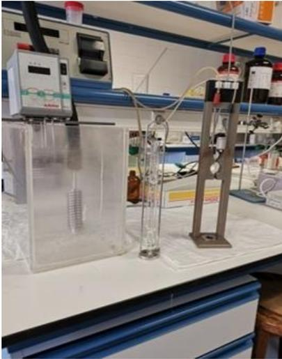
Figura 6. Viscosímetro capilar Ubbelohde de Schott Geräte.
