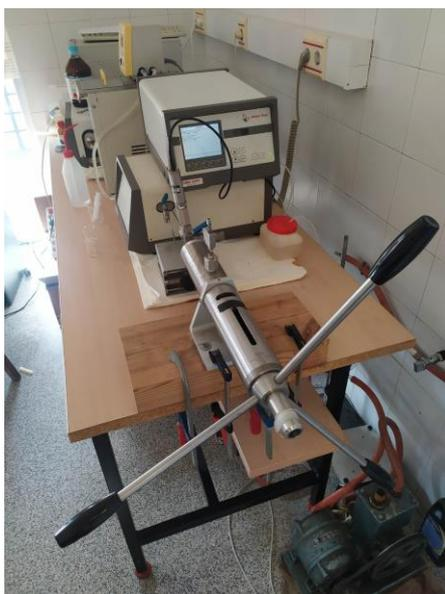
Figura 1. Analizador PVT Anton Paar DMA 5000
