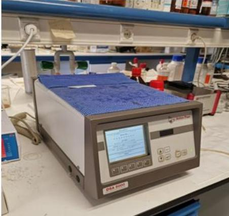
Figura 2. Analizador de densidad y velocidad de propagación del sonido Anton Paar DSA-5000.
