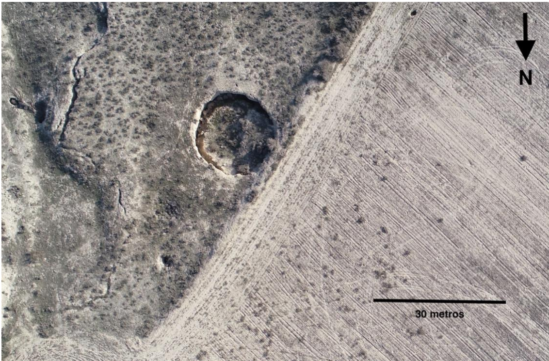
Figura 7. Fotografía del dron de una dolina simple no anidada subcircular (Eje mayor: 10,7 m; Re: 0,94; Área: 79,7 m 2 ; Perímetro: 32,7 m; Rc: 0,93; Volumen: 5900 cm 3 ; Profundidad: 1,6 m).
