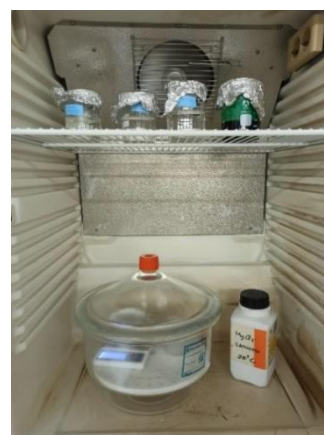
Imagen 11. Cámara de temperatura controlada con desecador y sales saturadas.
