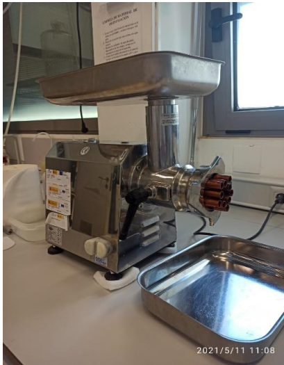
Imagen 4. Picadora de carne modificada para la extrusión de piensos
