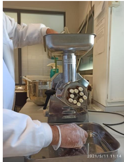
Imagen 5. Proceso de salida de los gránulos o pellets
