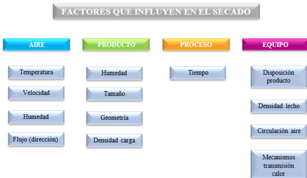
Figura 8. Esquema de los factores de variación del proceso de secado. Fuente: elaboración propia (Fito Maupoey et al., 2020).
