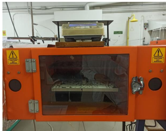
Imagen 9. Cámara de pesado del túnel de secado
