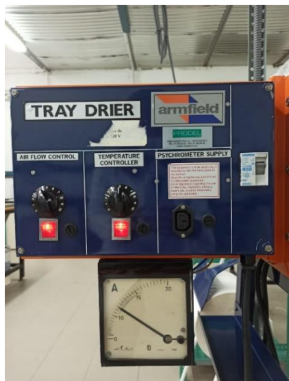
Imagen 8. Controladores de temperatura y velocidad de aire del túnel de secado
