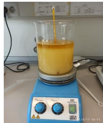
Imagen 2. Agitador magnético utilizado en la emulsión de los ingredientes fluidos
