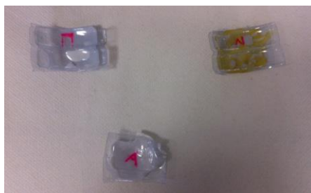
Figura 10: Test de diferentes maneras de sellado. (A) resina acrílica, (N) cola de neopreno, (U) resina de poliuretano.
