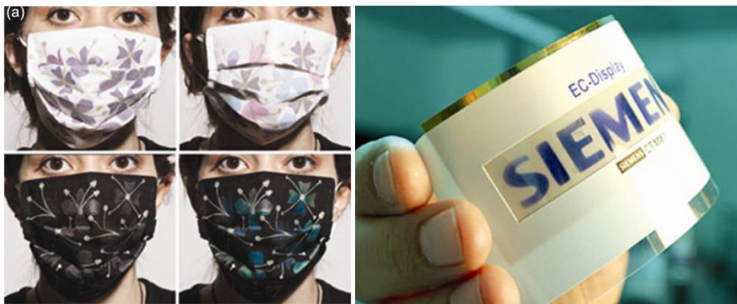
Figura 1: a. Mascarillas de textil electrocrómico 1 . B. Pantalla electrocrómica flexible desarrollada por Siemens 1 .
