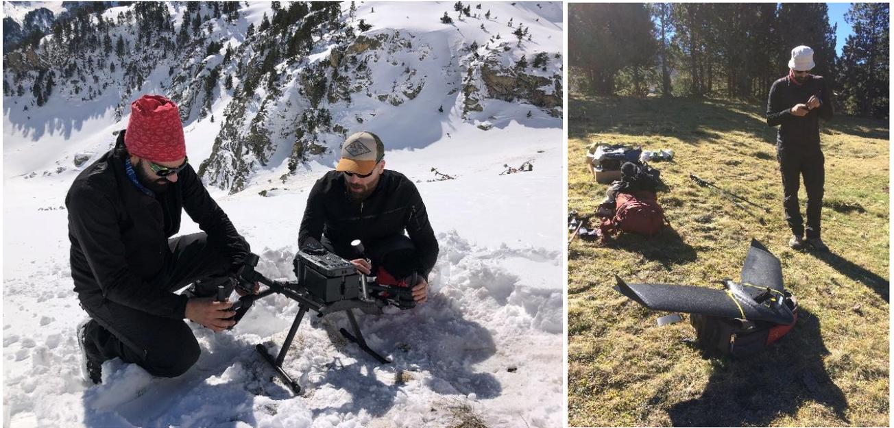
Figura 5. Fotografías del UAV *multirotor DJI Matrice 300 RTK* (izquierda) y el *Sense Fly* de ala fija *Ebee X RTK* (derecha) en el marco de las campañas de campo.
