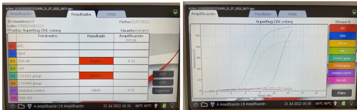
Figura 20.- Resultado positivo de una cepa productora de OXA-48 y BLEE CTX-M del grupo 1 en Eazyplex® Superbug CRE (Amplex).
