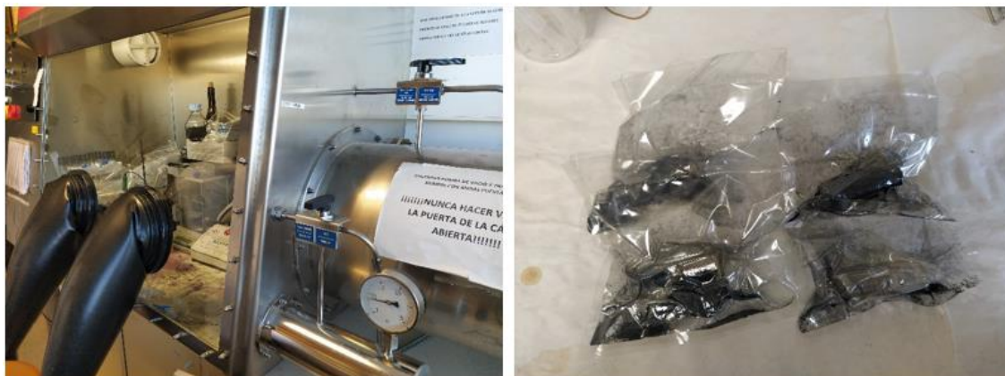
Figura 2. Cámara de anoxia y viales en bolsas termoselladas con carbón activo
