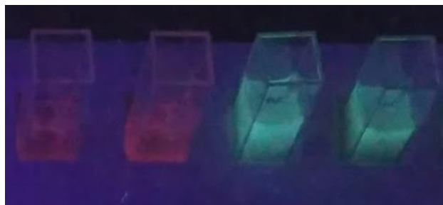
Figura A.1B.4: Aspecto bajo la exposición a luz UV-vis de las AuNPs sintetizadas térmicamente de izda a derecha a 100, 200, 300 y 500 °C.
