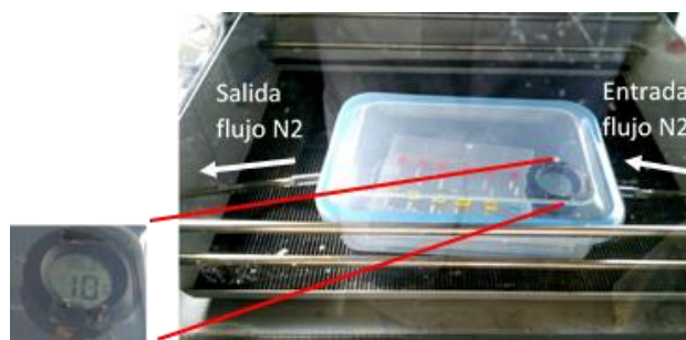
Figura 3C.11: Cámara de secado casera con flujo continuo de N 2 y control de humedad y temperatura.
