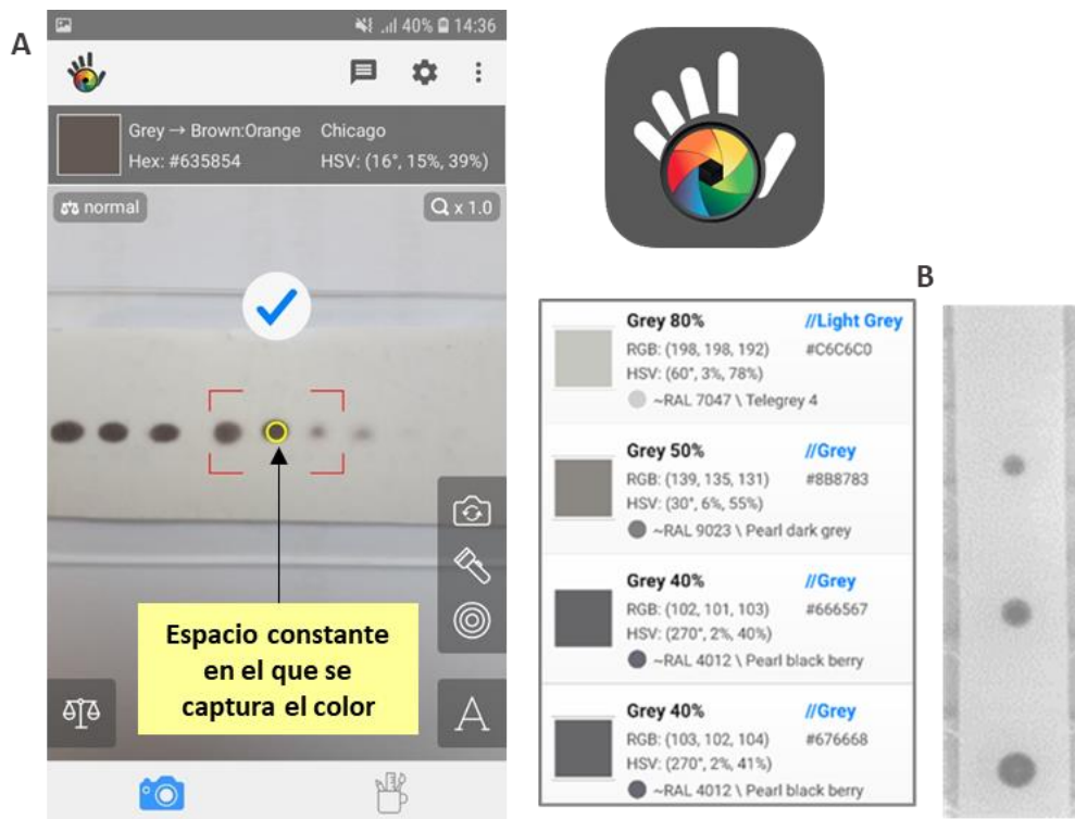
Figura 3C.23: A) Interfaz de la aplicación Color Grab disponible en Google play B) Información colorimétrica proporcionada por la aplicación en los códigos de color RGB o HSV, para cada una de las señales del papel termosensible evaluadas.
