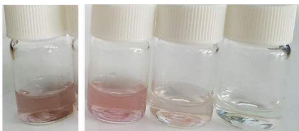
Figura A.1B.1: Aspecto de las AuNPs sintetizadas térmicamente de izda a derecha a 300, 500, 600 y 700 °C.
