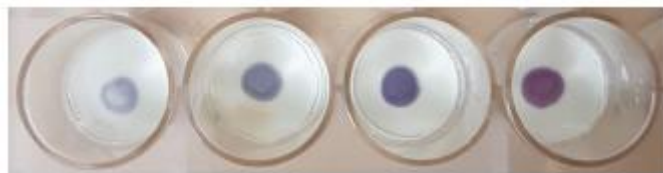
Figura 2.5: Soportes de celulosa que contienen inmovilizada una enzima modelo y Au(III). Tras la adición del sustrato, se observa la aparición de colores que indican la formación de AuNPs.
