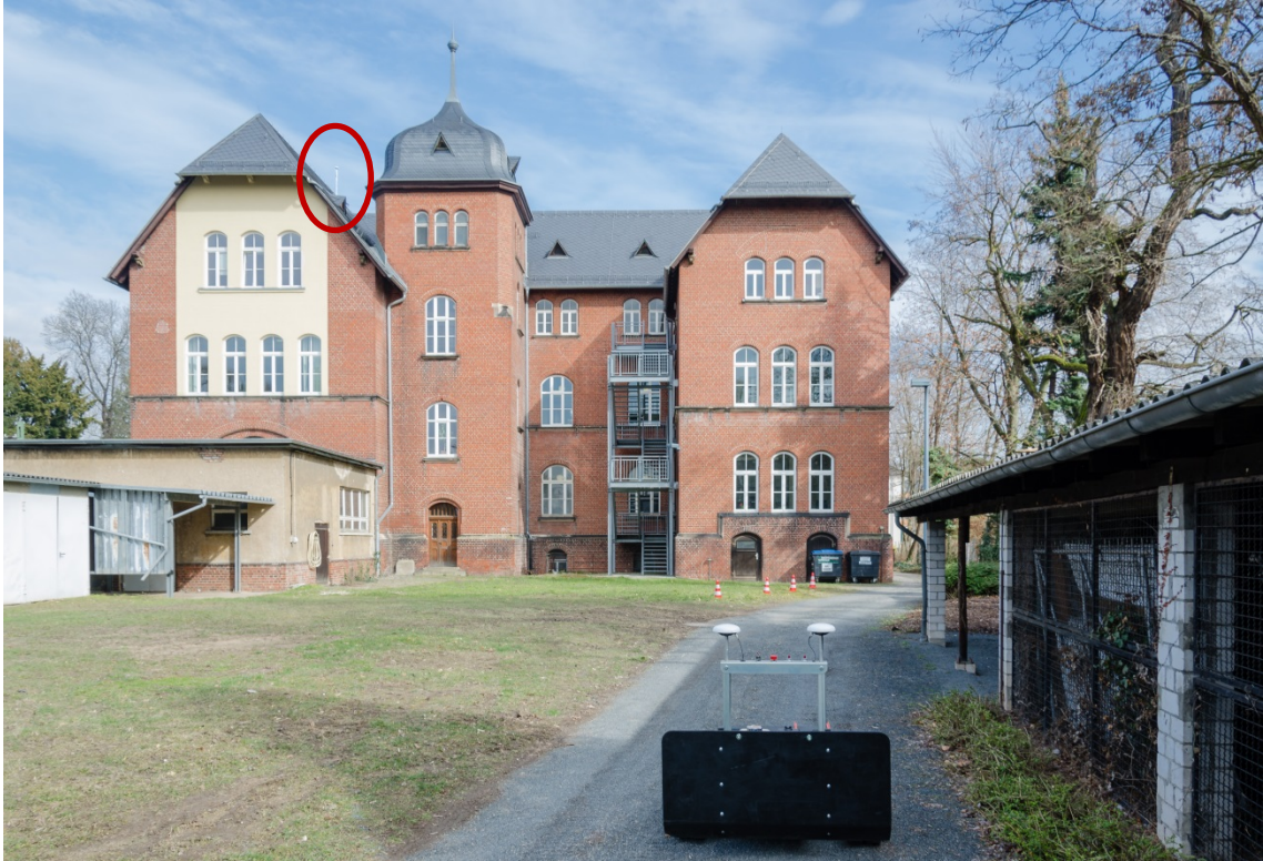
Abb. 91 Erste Erprobungsfahrten mit Neosat Alpin im Hof des Institutes für Technik. Rote Markierung: Position der RTK-Basis.
