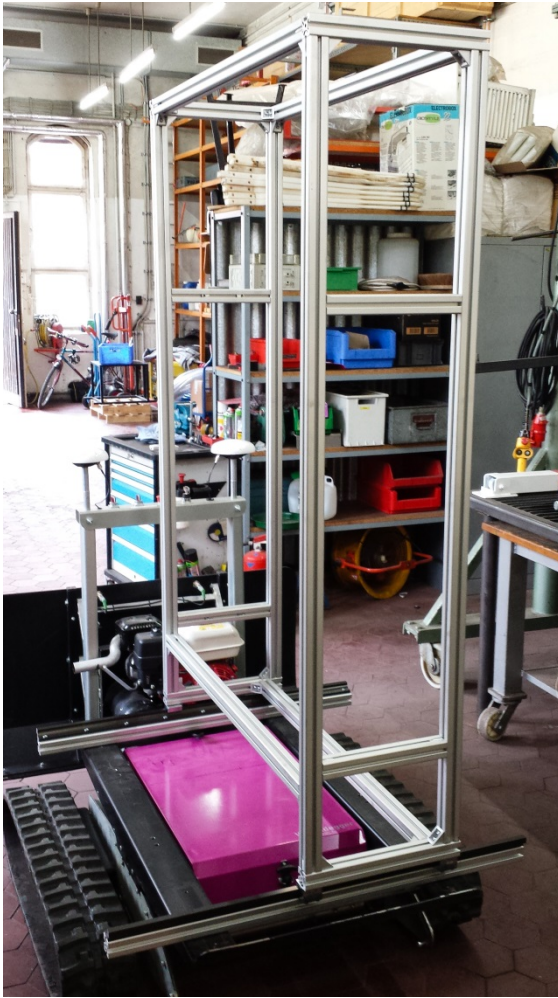
Abb. 51 Montage des Grundrahmens der Kamera- lageregelung. Horizontalverschiebung.
