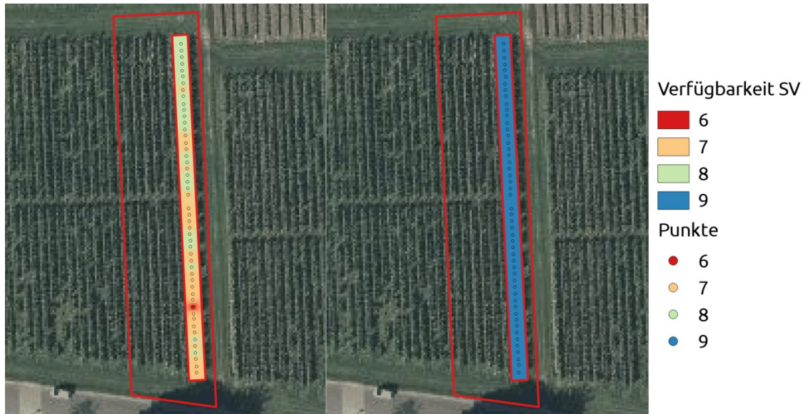
Abb. 98 Choroplethenkarte zur Visualisierung der SV-Verfügbarkeit in Reihe 33, Versuchsanlage Rebenzüchtung HS Geisenheim am 10. September 2014. Links: Einstellung GPS-Antennen 1280 mm über Grund ( ant_unten ); Rechts: Einstellung GPS-Antennen 2000 mm über Grund ( ant_oben ).
