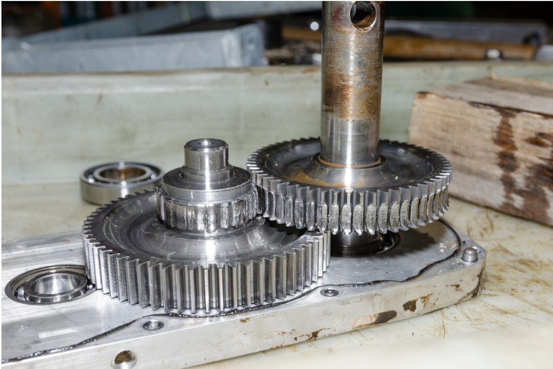
Abb. 108 Getriebedefekt am Fahrtrieb durch Abscheren der Zahnradflanken.
