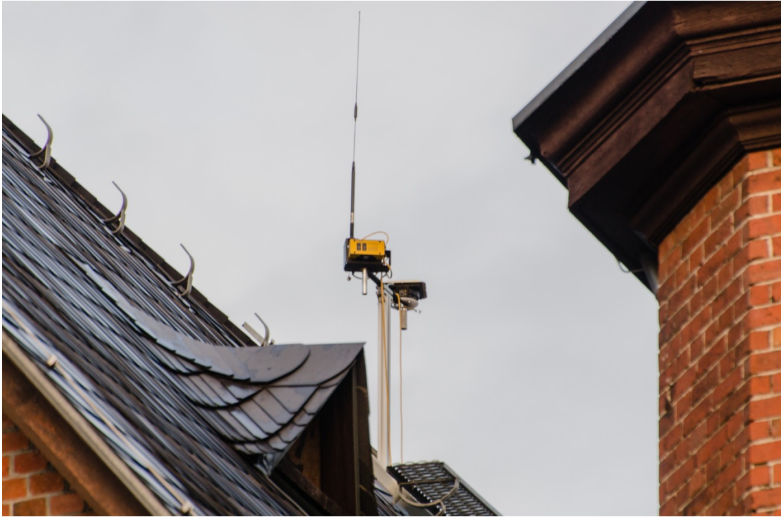
Abb. 27 GPS-Antenne (rechts) und Funkmodem (links) der Referenzstation (Trimble) auf dem Dach des Institutes für Technik, Hochschule Geisenheim.
