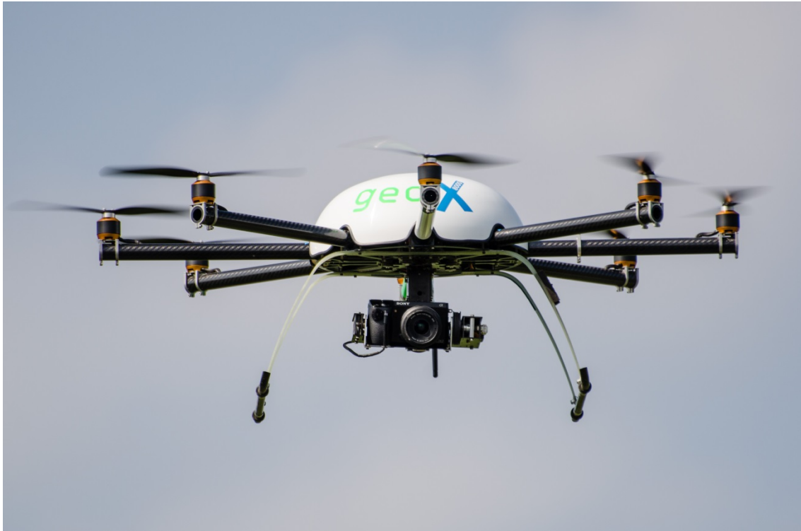
Abb. 20 Drohne (Octocopter) der Firma geo-konzept bei einer Vorführung bestückt mit einer handelsüblichen Systemkamera der Fa. Sony zur Erzeugung von 3D-Geländeaufnahmen.
