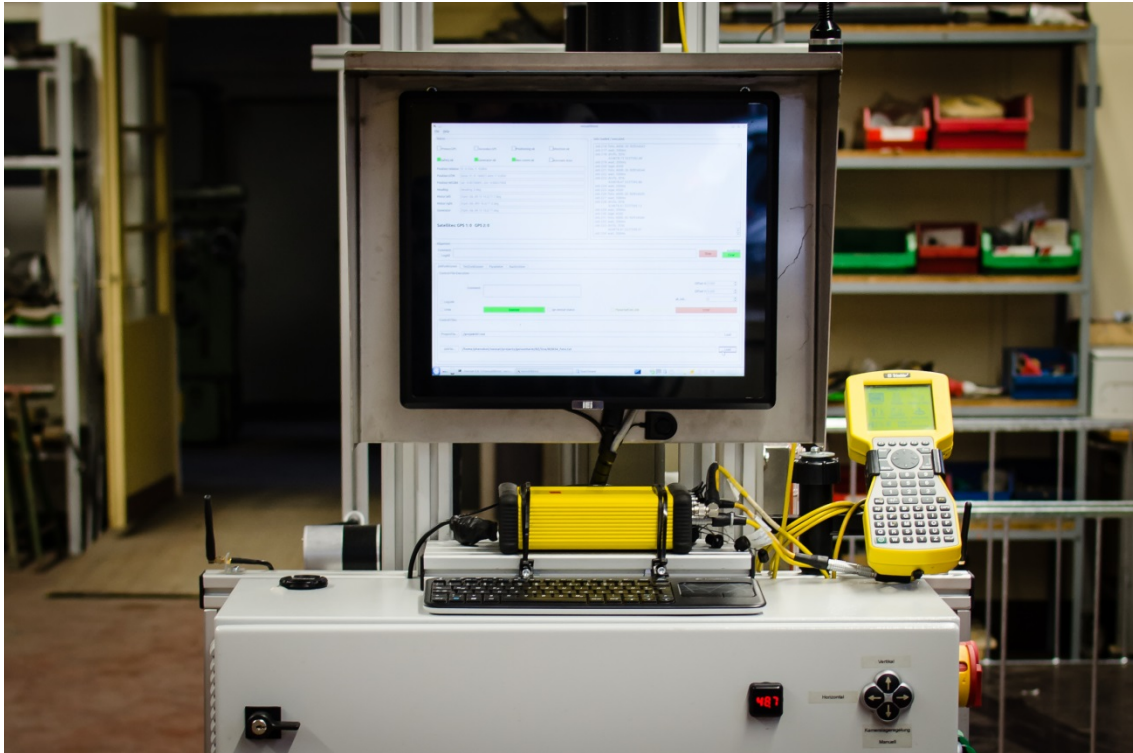
Abb. 66 Bedientableau Schaltschrank mit Touch-LCD und Maus-Tastaturkombination. Hier ist zusätzlich der Rover des RTK-Systems von Trimble mit TSC 1 angebaut.
