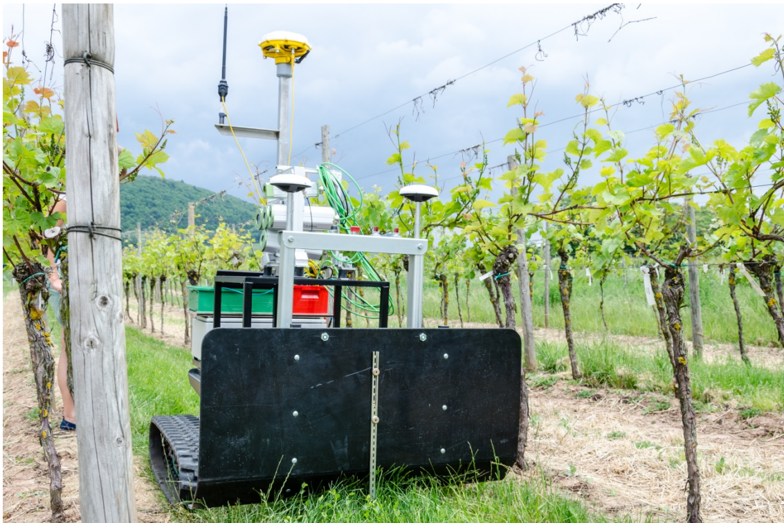
Abb. 107 Versuchsträger Neosat Alpin mit statisch montiertem MKS in Parzelle 19 während der ersten Erprobung am JKI.
