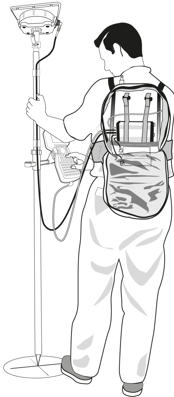
Abb. 29 Lotrechte Ausrichtung der GNSS-Antenne über dem Messpunkt bei einer Echtzeitkinematischen Messung, modifiziert nach TRIMBLE (1998).
