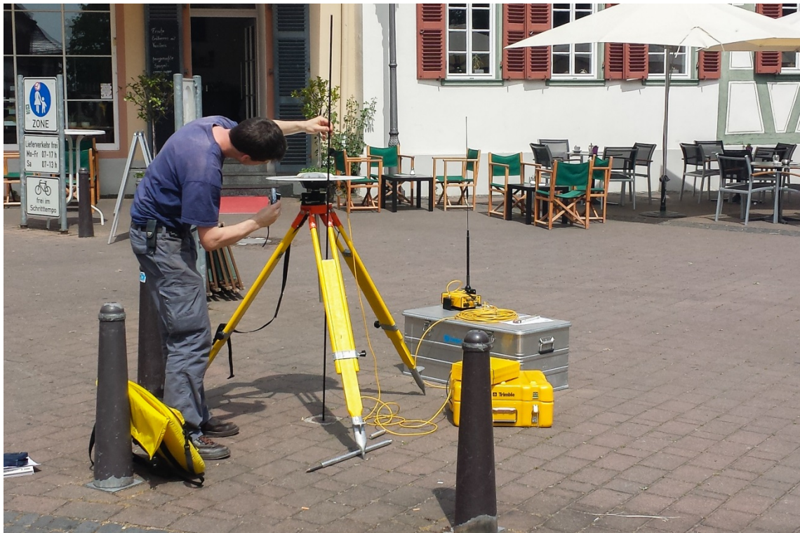
Abb. 25 Einrichten der Referenzstation auf dem Lagefestpunkt TP 601380/04 Geisenheimer Domplatz.
