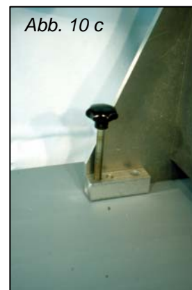
Abb. 10 a- d: a) Bandsäge mit Kühlanschlag, b) Kühlanschlag, c) Einstellschraube des Kühlanschlags, d) Kühlanschlag mit Kühlakkus bestückt
