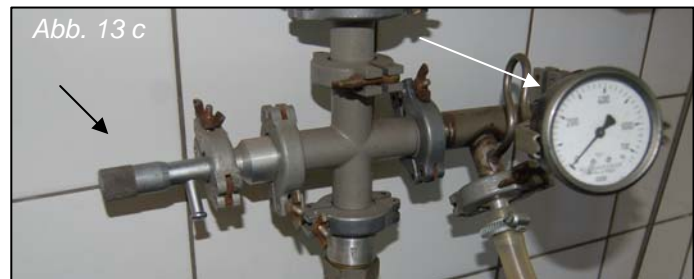
Abb. 13 a- c: a) Vakuumglocke b) Vakuumkammer mit Manometer (weißer Pfeil: Manometer) c) Regulierungseinheit für die Vakuumpumpe der Vakuumglocke (schwarzer Pfeil: Regulierungsventil-Schraube, weißer Pfeil: Manometer)
