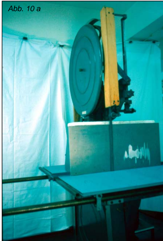
Abb. 10 a- d: a) Bandsäge mit Kühlanschlag, b) Kühlanschlag, c) Einstellschraube des Kühlanschlags, d) Kühlanschlag mit Kühlakkus bestückt
