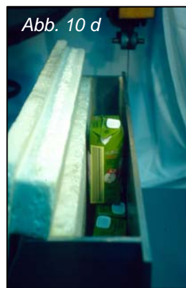
Abb. 10 a- d: a) Bandsäge mit Kühlanschlag, b) Kühlanschlag, c) Einstellschraube des Kühlanschlags, d) Kühlanschlag mit Kühlakkus bestückt
