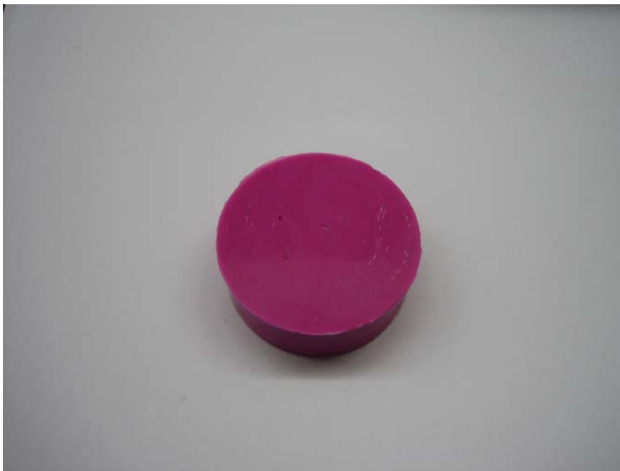
Abb. 5: Prüfkörper zur Ermittlung der Kugeldruckhärte
