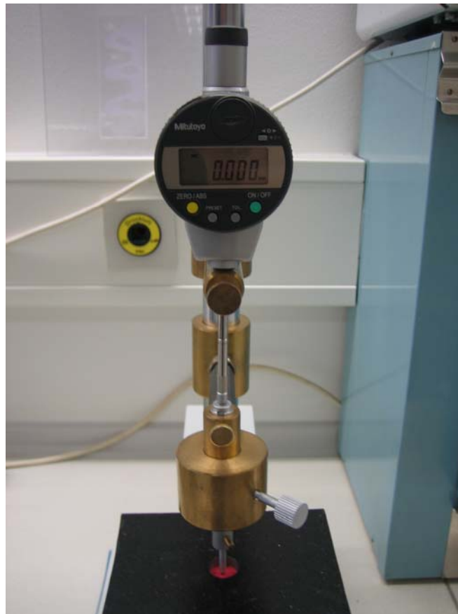
Abb. 7: Messung der Kugeldruckhärte
