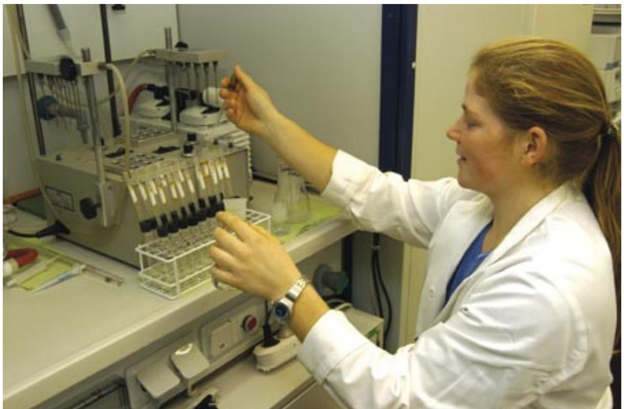
Abb. 2: TA Yvonne Schmitz beim Endschrift in der Präparation der Proben zur Harnsteroidprofilanalyse mittels GC-MS. Die derivatisierten Extrakte werden gelchromatographisch an Lipidex 5000 Mini-Säulen gereinigt.
