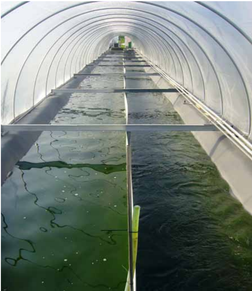
■ Abb. 6: Halboffener Pond der Algenland GmbH zur Anzucht von Mikroalgen
