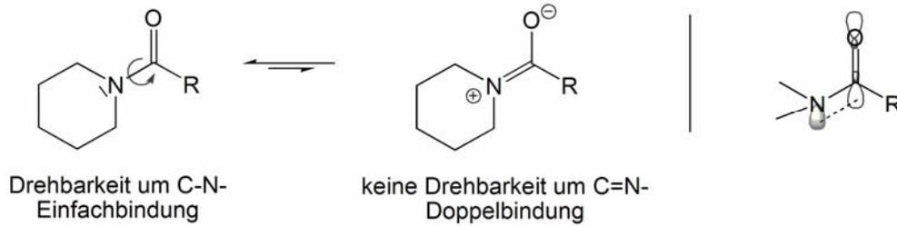
**Abb. 4-29: Partieller Doppelbindungscharakter schränkt Drehbarkeit um C-N-Bindung in Piperidinamiden **104** ein: darstellbar über Ladungsverteilung (li) und Orbitalbetrachtung (re)**
