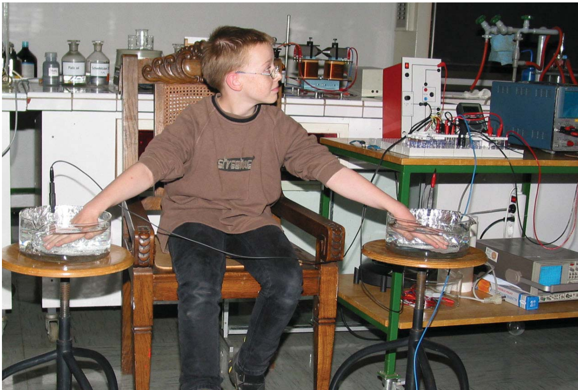
Abb. 13 Aufnahme eines EKG während der Vorlesung (unten) und die schematische Versuchsanordnung.
