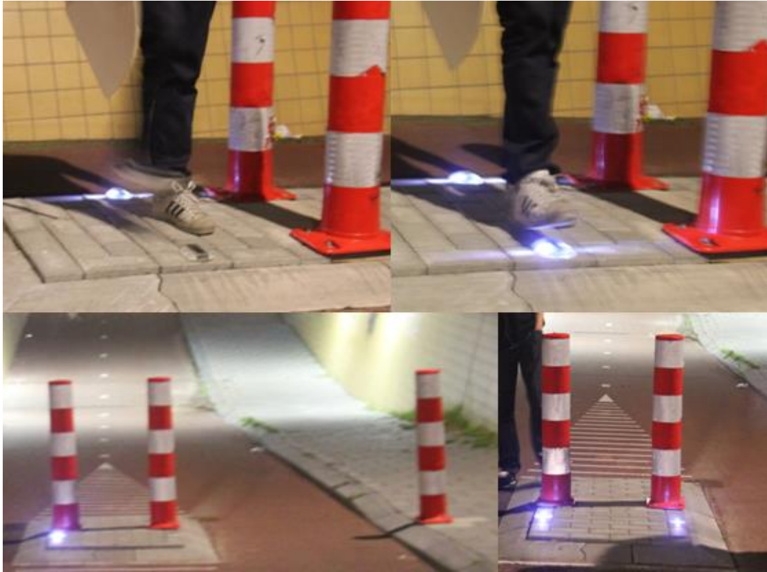
Figuur 21: Het door de invloed van straatverlichting niet ingeschakelde led lampje (links) en het wel ingeschakelde led lampje bij blokkeren van de straatverlichting (schaduw-rechts).
