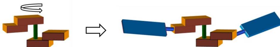
Figuur 3. 'Moleculaire roerder' afgeleid van een eerste generatie licht-aangedreven moleculaire motor.
