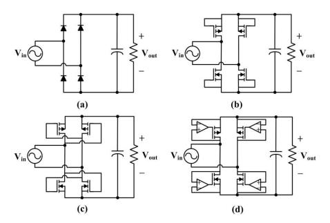
Figure 1.3. Voltage bridge rectifiers: (a) p-n junction diode rectifier, (b) diode-connected MOSFET rectifier [55], (c) cross coupled MOSFET rectifier [56], [57], and (d) active diode rectifier [58], [59].
