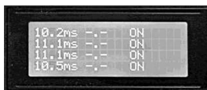
Рисунок 10. Контроль времени впрыска топлива на дисплее разработанного прибора «ДБД-4» Источник: составлено авторами
