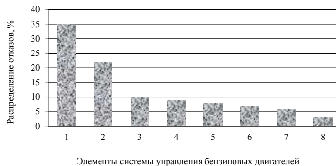
Рисунок 2. Распределение отказов по элементам системы управления бензиновых двигателей: 1 – электрические цепи (окисление и обрыв проводов) (35%); 2 – электробензонасос (22%); 3 – регулятор холодного хода (10%); 4 – элементы системы зажигания (9%); 5 – форсунки (8%); 6 – датчик кислорода (7%); 7 – реле (6%); 8 – электронный блок управления (3%)
