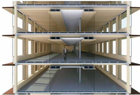
Figure 1.5. Construction hybride, système plafond à plancher bois-béton [26].
