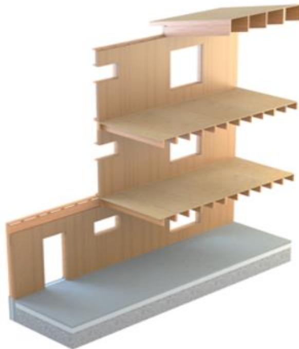
Figure 1.4 b Bâtiment en bois massif (CLT) [39].
