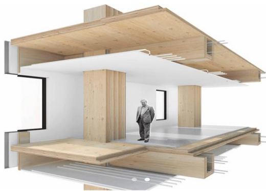
Figure 1.12. Système mécanique caché par un plafond suspendu [47].
