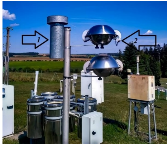
Obrázek 6: Pasivní vzorkovače užívané v síti GAPS; 1 XAD vzorkovač, 2 vzorkovač s PUF (foto autor).
