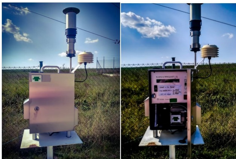
Obrázek 7 Aktivní vzorkovač ovzduší, NAOK, typ LVS3/MVS6, Steven Leckel (foto autor).
