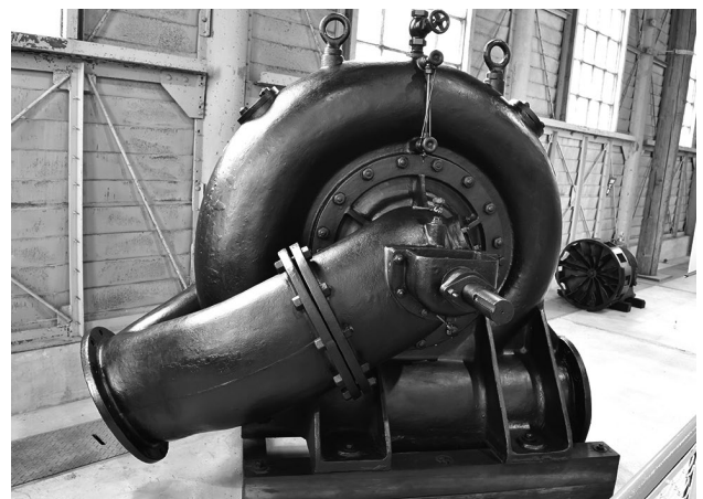
写真15 みのくち渦巻ポンプ Photo 15. Prof. A Inokuty Centrifugal Pump
