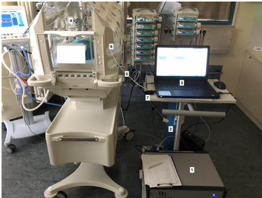
Abbildung 3 Aufbau MCC-IMS auf Station
