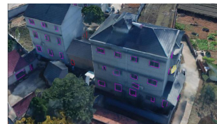
图8 窗户的聚类结果 Fig. 8 Clustering result of windows
