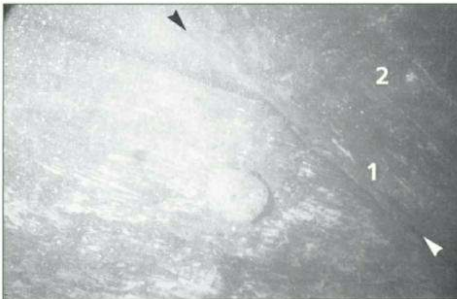
FIG. 34 – About d'une virure dans la râblure (1) de l'étambot (2).
