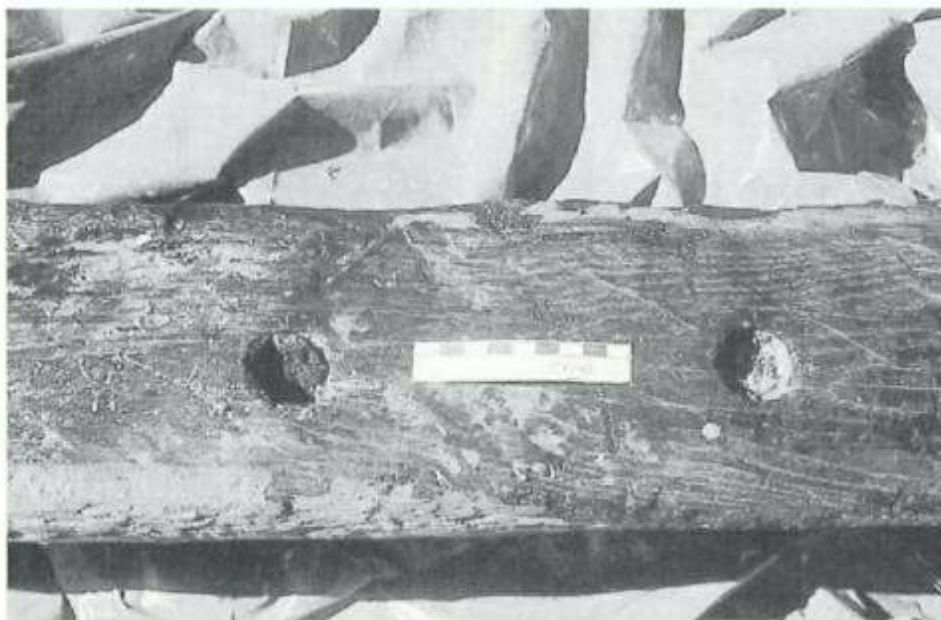
FIG. 59 – Gournables brisées à l'extrémité de la branche rive gauche de la pièce TRV10.
