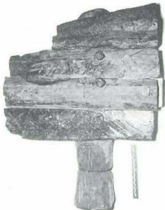
FIG. 83 – Tête des gournables sur la face externe du bordé.
