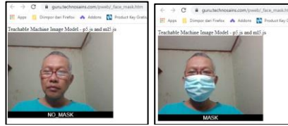
Gambar 5. Contoh pengujian detektor masker berbasis web Hasil pengujian seseorang bermasker dan tidak bermasker dapat dilihat pada Tabel 1.
