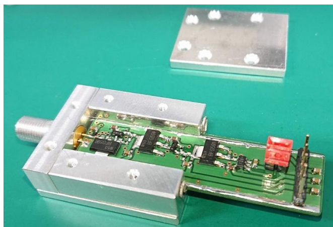
図 5.4 パルスレーザーの写真。パルス整形回路と LD は、熱伝導を考慮した小さなアルミの箱の中に入っている。アルミボックスは光ファイバーと接続できるように設計している。
