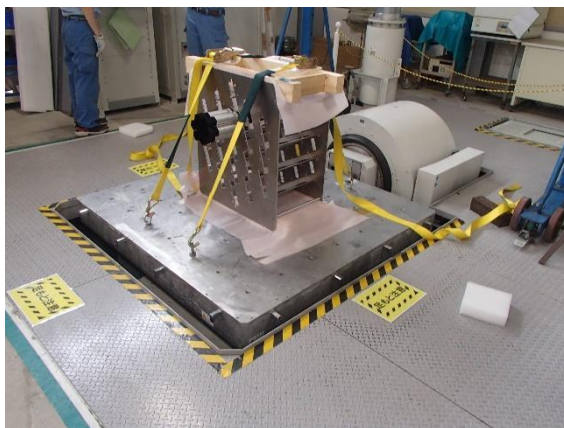
図 3.2 振動試験装置にミニスケールのカメラフレームを固定して、そこに PMT module を 1 台搭載して試験した。
