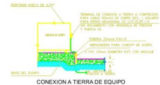
CONEXION A TIERRA DE EQUIPO
