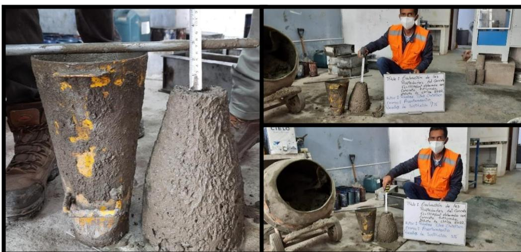
Figura 9: Ensayo de consistencia del concreto
