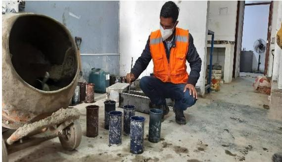
Moldeo de probetas
