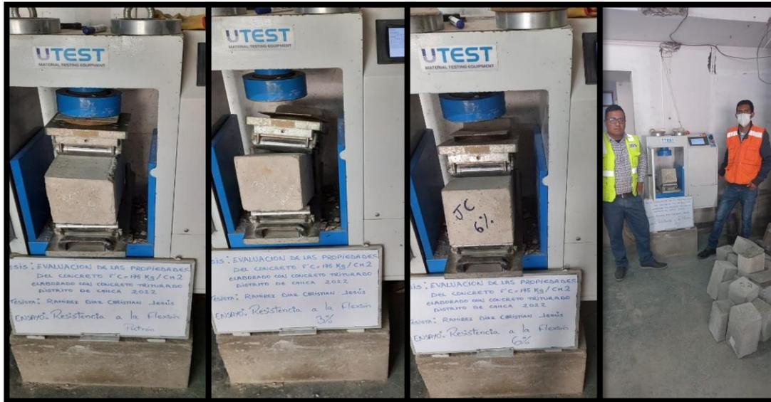
Figura 8: Ensayo de resistencia a la flexión de vigas prismáticas de concreto
