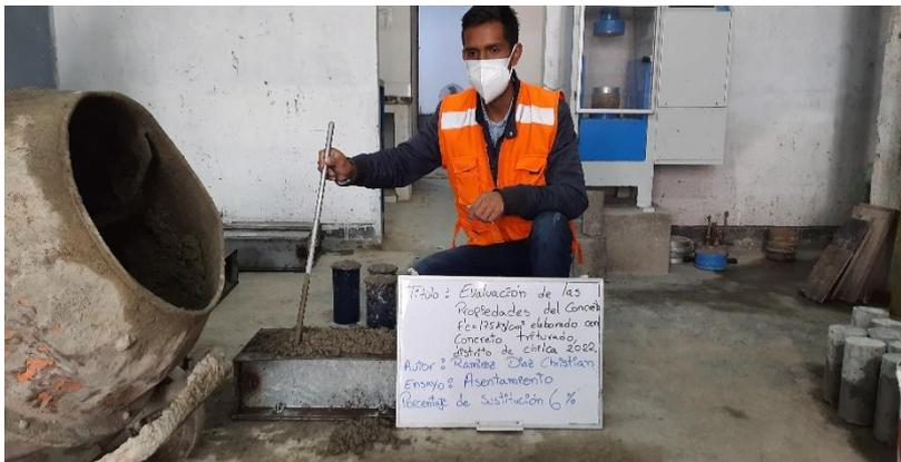
Moldeo de viga prismática
