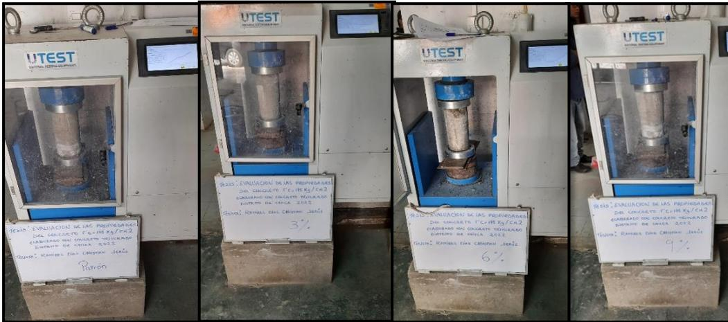
Figura 7: Ensayo de resistencia a la compresión de probetas de concreto
