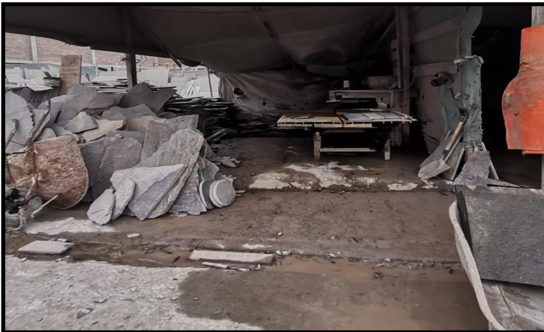
Figura 33. Área de corte de laja sin espacio adecuado
