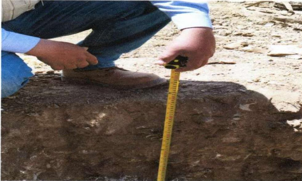
FOTO N°06: EXCAVACION DE LA CALICATA C-03
