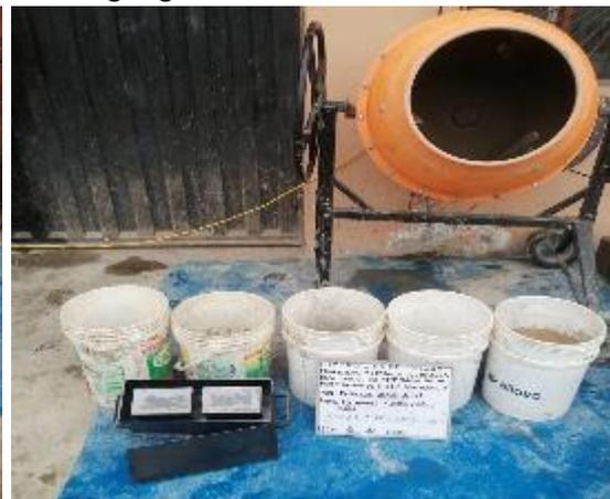
Dosificación para ladrillo con agregado reciclado al 100%
