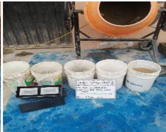
Dosificación para ladrillo con agregado reciclado al 50%
