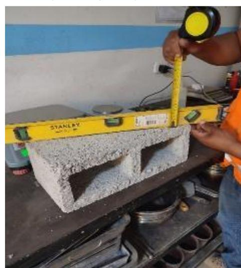
**Figura N°34:** Ensayo de alabeo 02
