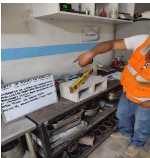
**Figura N°33:** Ensayo de alabeo 01
