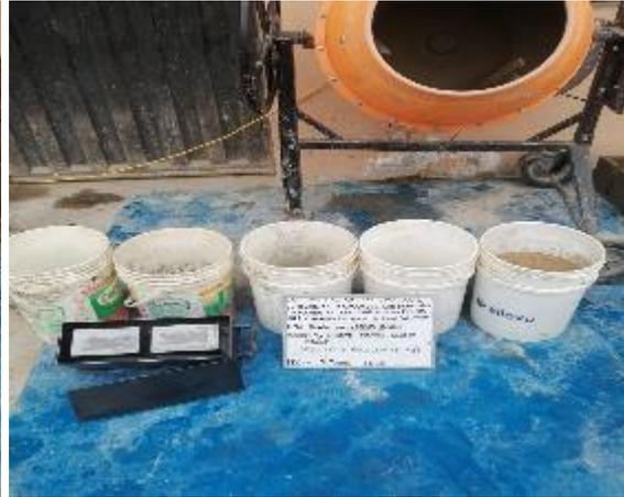
**Figura N°17:** Dosificación para ladrillo con agregado reciclado al 50%
