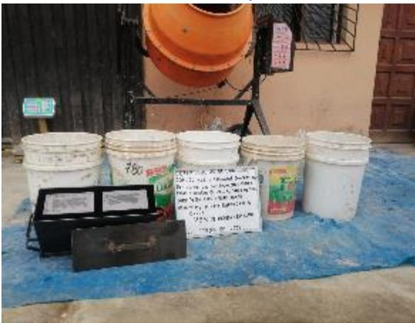
**Figura N°18:** Dosificación para ladrillo con agregado reciclado al 75%
