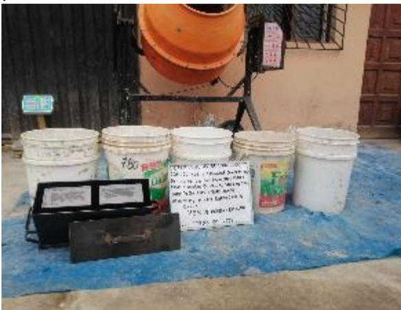
Dosificación para ladrillo con agregado reciclado al 75%
