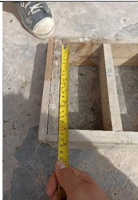
Figura35: Medición de adobera y mezcla de suelo con la incorporación de paja de trigo y fibra de cabuya
