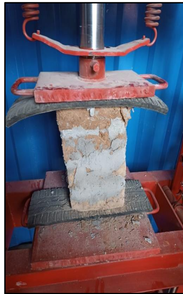
Figura 29: Esfuerzo a compresión P.P.A Fuente: elaboración propia
