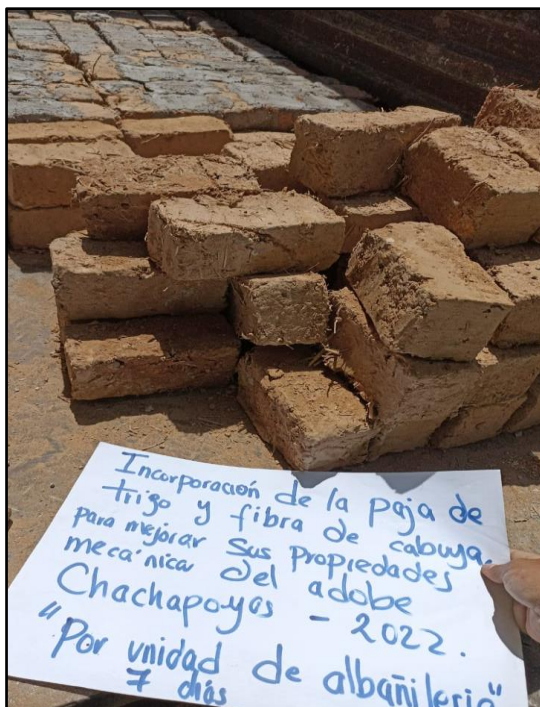
Figura 25: Unidad de albañilería
