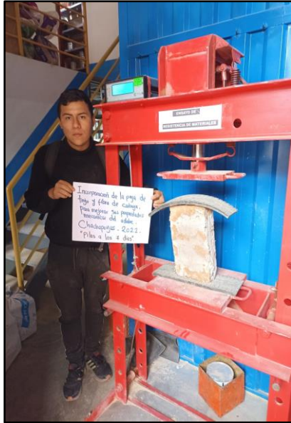
Figura 28: Pilas Axiales Fuente: elaboración propia
