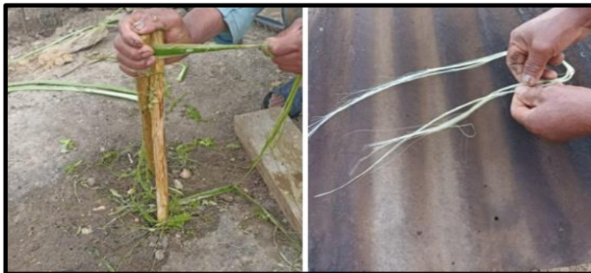
Figura 2. Extracción Fibra de cabuya Figura 3. Fibra de cabuya Fuente: Elaboración propia Fuente: Elaboración propia
