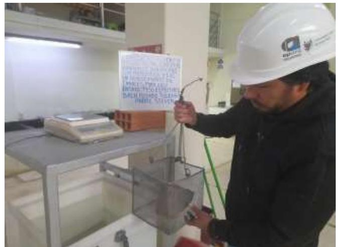
Fotografía 20 Introducción de fragmento de muestra experimental en canastilla al recipiente con agua para realizar ensayo de absorción
