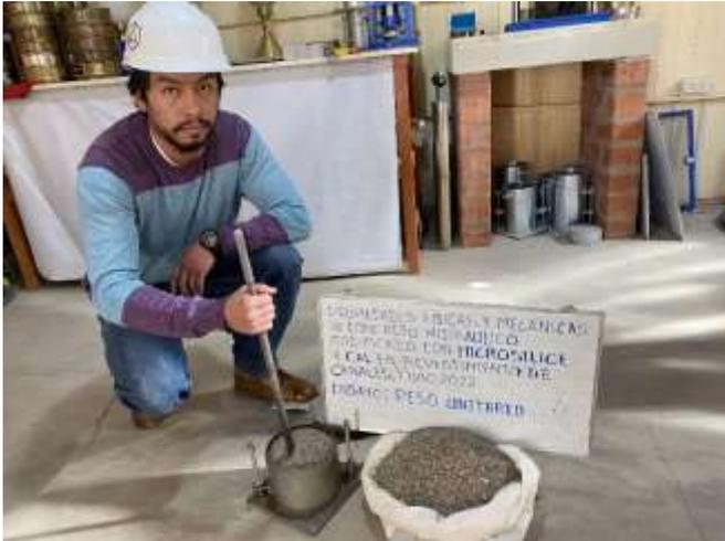
Fotografía 1 Realización de ensayo de Peso unitario en laboratorio
