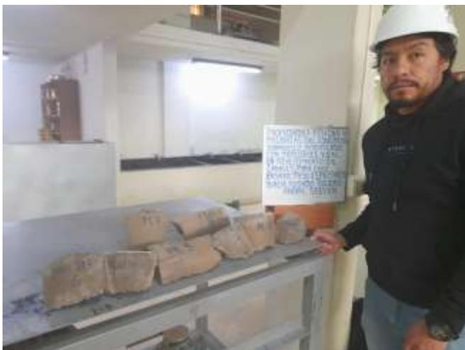
Fotografía 19 Previa preparación de muestras experimentales para realización de ensayo de absorción
