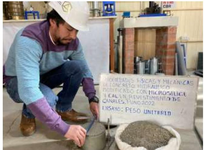
Fotografía 2 Afirmando de agregado en molde luego de varillado
