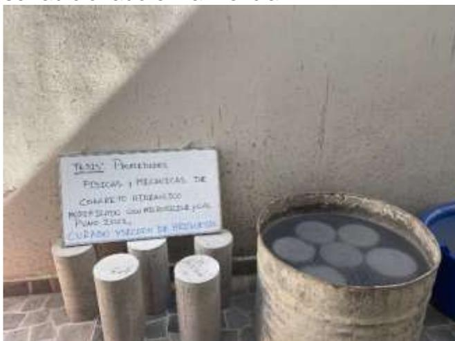
Fotografía 15 Curado y secado de briquetas según a su tiempo de elaboración
