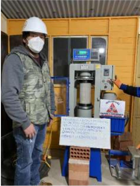
Fotografía 21 Muestra experimental introducida en prensa hidráulica para ejecución de ensayo de compresión
