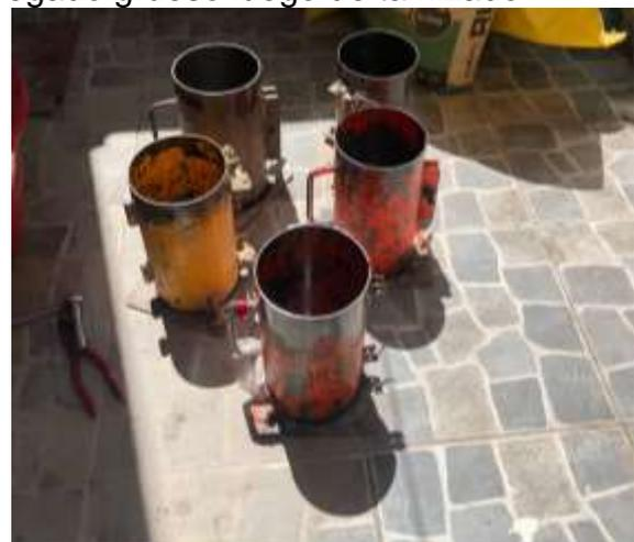
Fotografía 6 Preparado de moldes de briquetas para el respectivo moldeo
