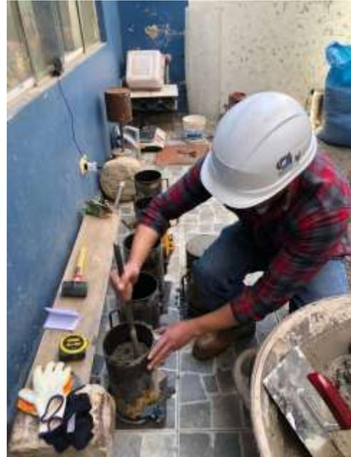
Fotografía 8 Varillado de concreto en capas de concreto en molde de briqueta
