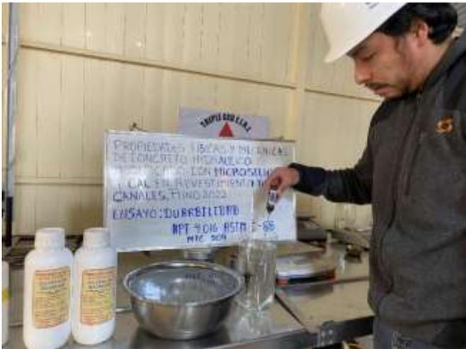
Fotografía 17 Determinación de temperatura de agua previo a realizar ensayo de durabilidad
