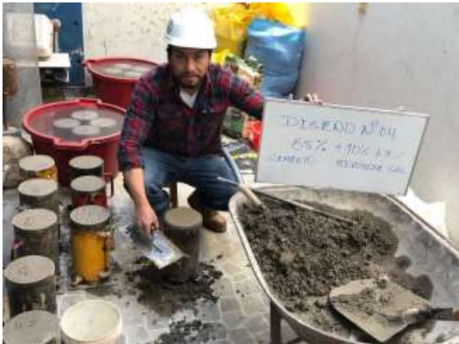
Fotografía 11 Moldeado y curado de muestras experimentales
