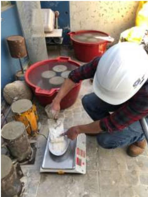
Fotografía 13 Pesado de cal en balanza para ser adicionado en la mezcla
