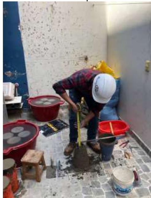
Fotografía 10 Determinación del Slump de concreto por medio de cono de Abrams
