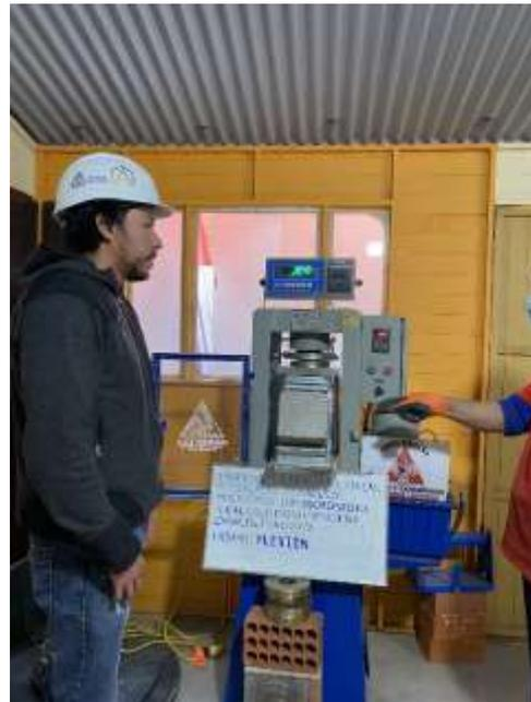
Fotografía 24 Ejecución de ensayo de flexión en muestras experimentales.
