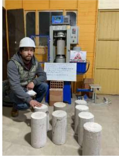
Fotografía 22 Muestras experimentales alineadas para realizar ensayo de compresión
