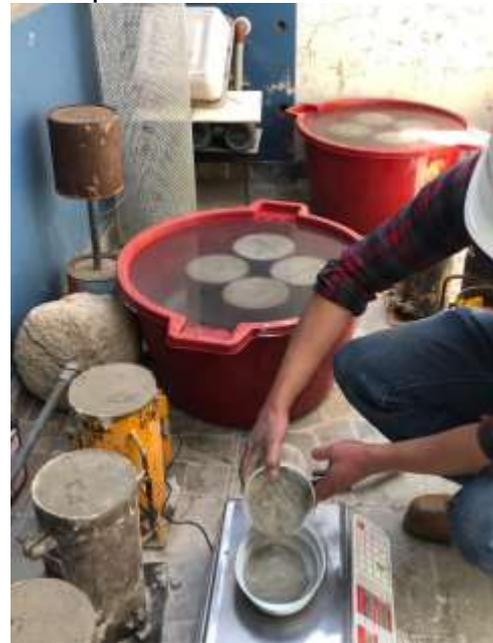
Fotografía 14 Pesado de microsilice para ser adicionado a mezcla
