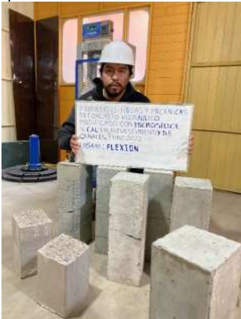
Fotografía 23 Fragmentado de vigas de muestra experimentales posterior a ser sometidas a ensayo de flexión.
