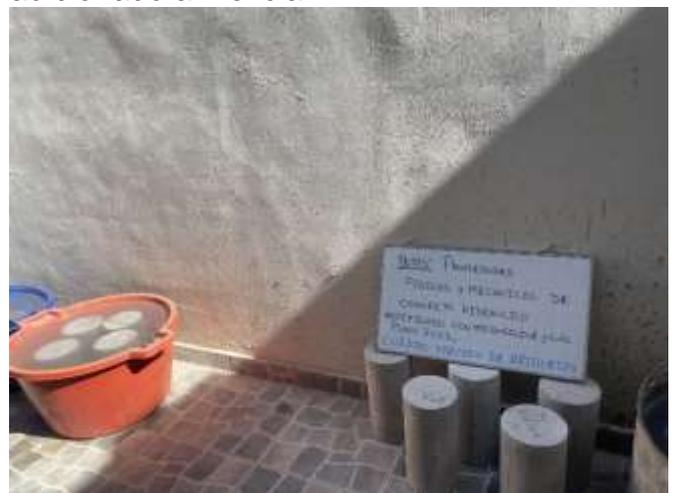
Fotografía 16 Curado y secado de briquetas según a su tiempo de elaboración
