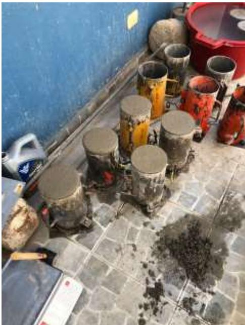
Fotografía 9 Moldeo de concreto en briquetas
