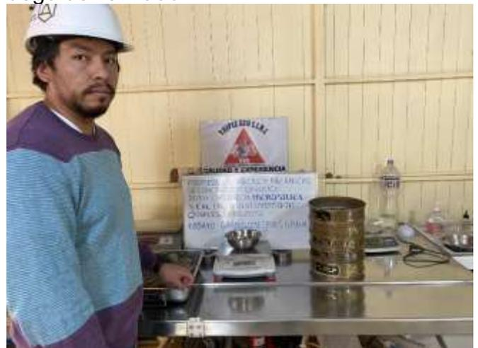
Fotografía 4 Determinación del peso de agregado grueso luego de tamizado
