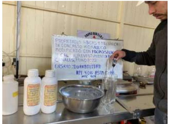
Fotografía 18 Determinación de peso específico en el agua luego de mezclar sulfatos de magnesio y sodio
