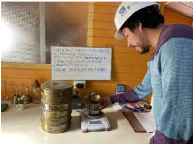
Fotografía 3 Determinación del peso de agregado fino luego de tamizado
