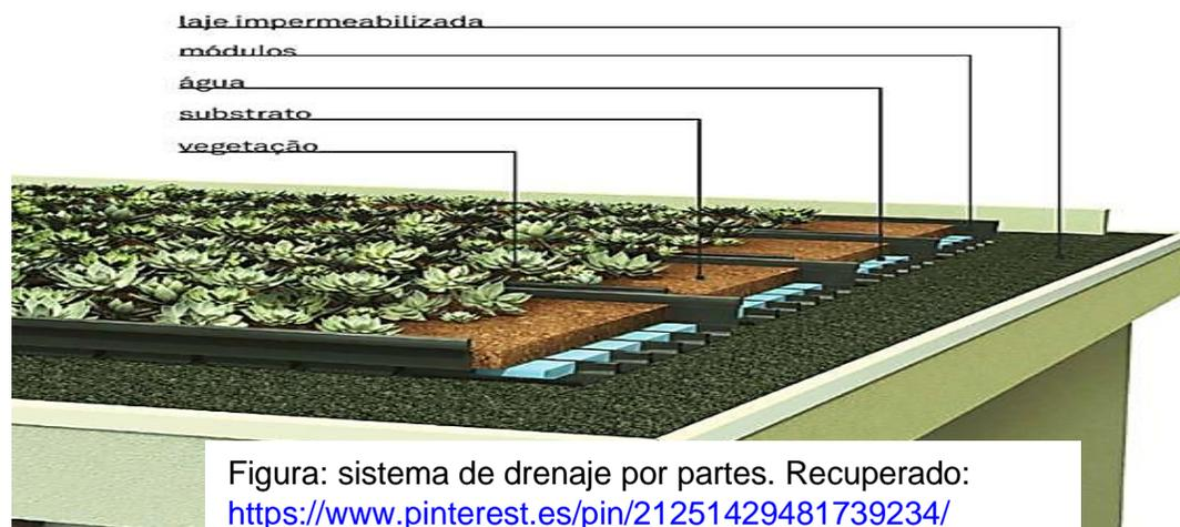
Figura: sistema de drenaje por partes. Recuperado: <https://www.pinterest.es/pin/21251429481739234/>
