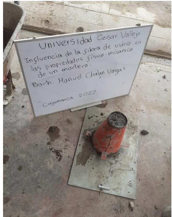
Pruebas de slump según lo establecido en la norma NTP; 339.035
