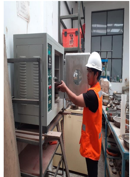
Ensayo para para la obtención de absorción y peso específico de acuerdo a la norma NTP; 400.021
