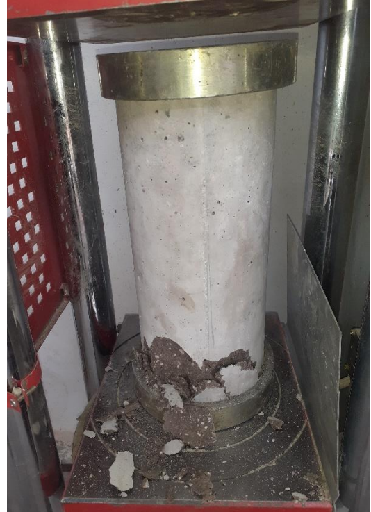
Ensayo de resistencia a la compresión de acuerdo a la norma NTP; 339.034
