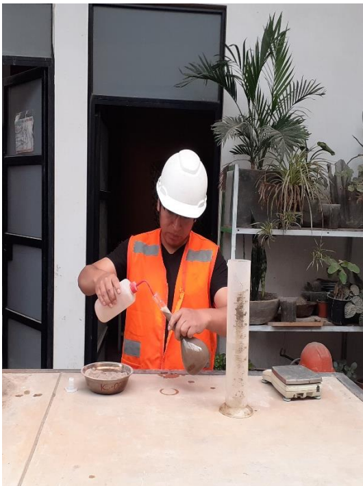
Ensayo para para la obtención de absorción y peso específico de acuerdo a la norma NTP; 400.021
