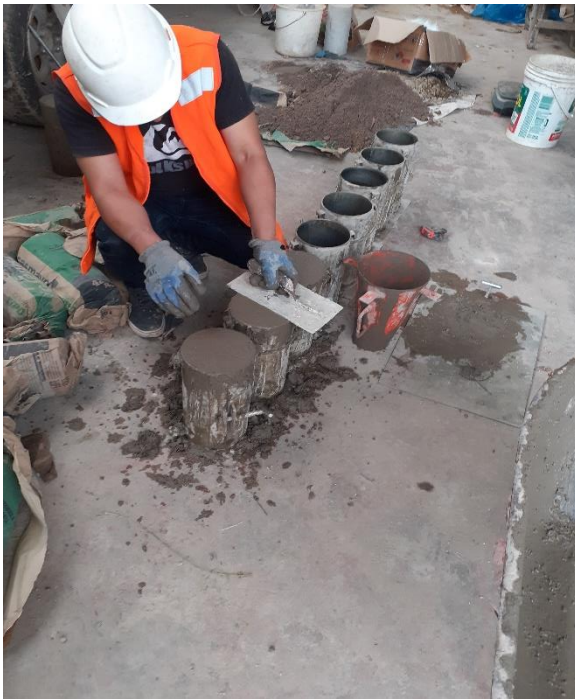
Elaboración de probetas
