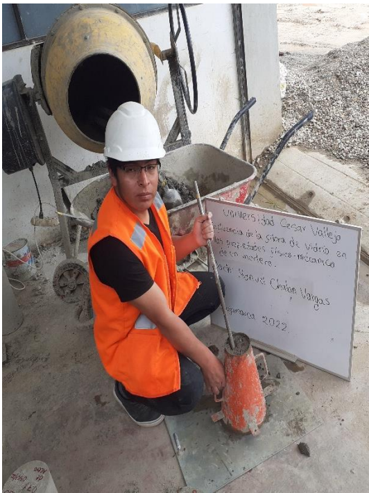
Pruebas de slump según lo establecido en la norma NTP; 339.035
