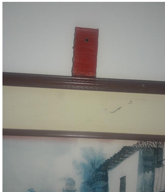
Figura 72. Prototipo cámara de vigilancia con ESP32
