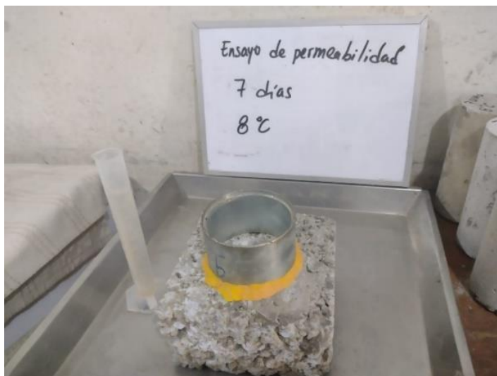
Figura 16. Ensayo de permeabilidad
