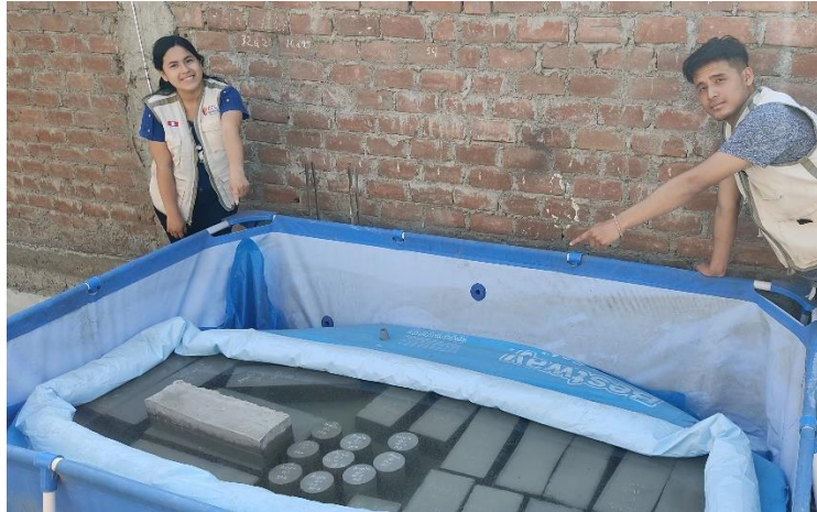
Figura 26. Estudiantes señalando los especímenes cilíndricos en la piscina de curado.
