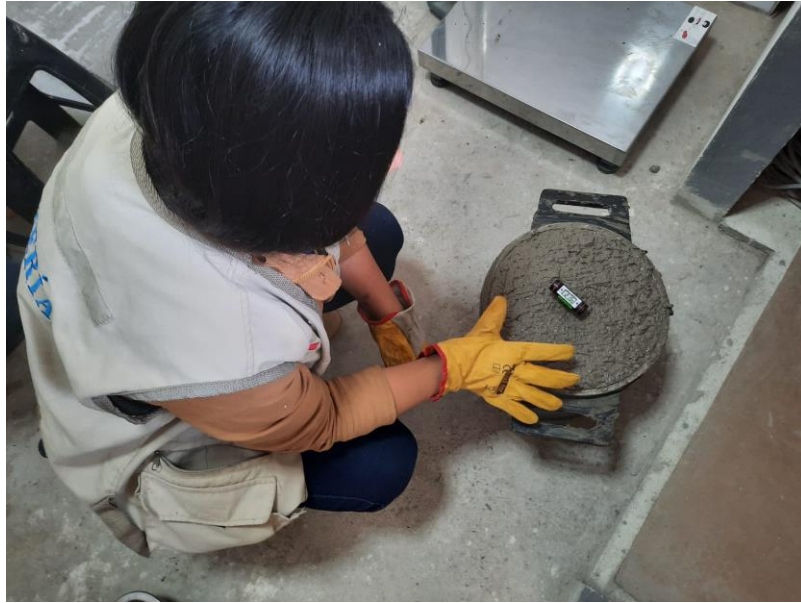
Figura 22. Estudiante realizando la toma de temperatura el concreto en estado fresco.
