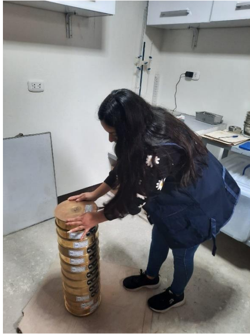
Figura 19. Tesista utilizando los tamices para el ensayo granulométrico del agregado fino.
