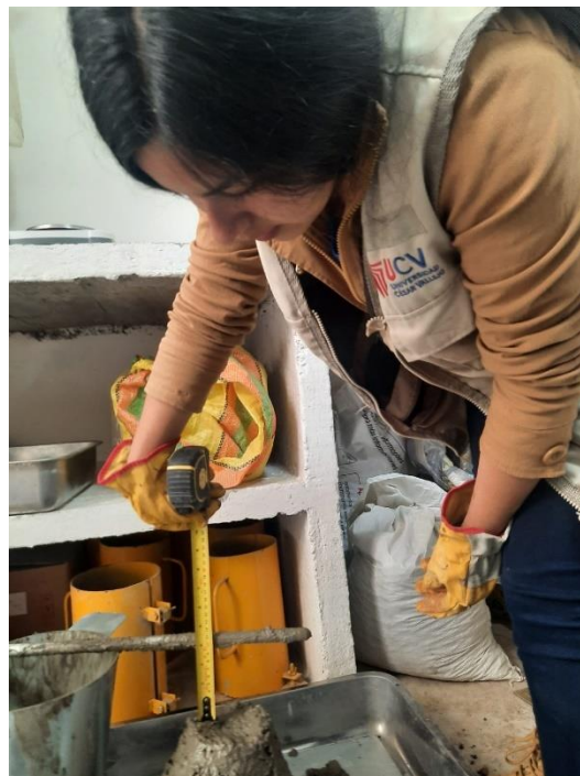
Figura 21. Estudiante realizando la toma de medida del asentamiento.
