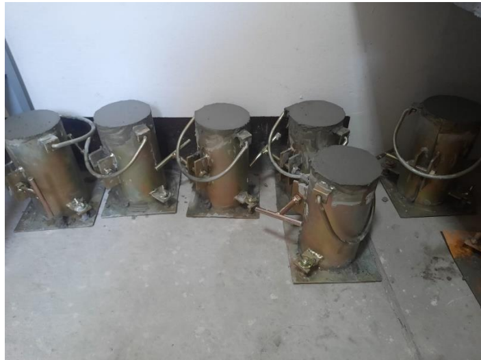
Figura 25. Probetas cilíndricas recién llenadas de concreto con distintos diseños. Una vez pasada las 24 horas se procedió a desmontar los moldes con mucho cuidado para conseguir el testigo de concreto y que este no tenga fracturas, inmediatamente después se colocó en la piscina de curado no sin antes escribir sobre una marca para diferenciarlo de los demás.
