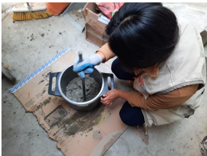
Figura 23. Estudiante realizando el llenado del recipiente con mezcla para luego ser pesado en una balanza.
