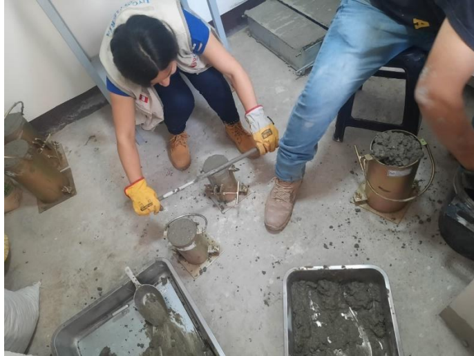
Figura 24. Estudiante realizando el llenado del recipiente con mezcla para luego ser pesado en una balanza.
