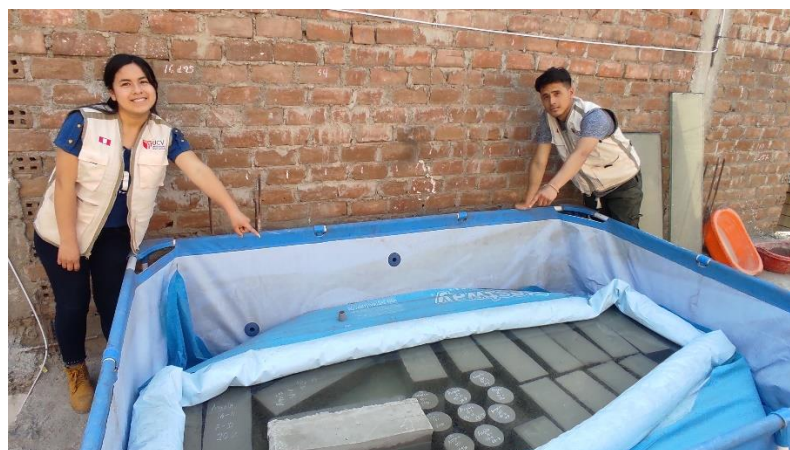
Figura 28. Estudiantes señalando los especímenes de tipo viga en la piscina de curado.
