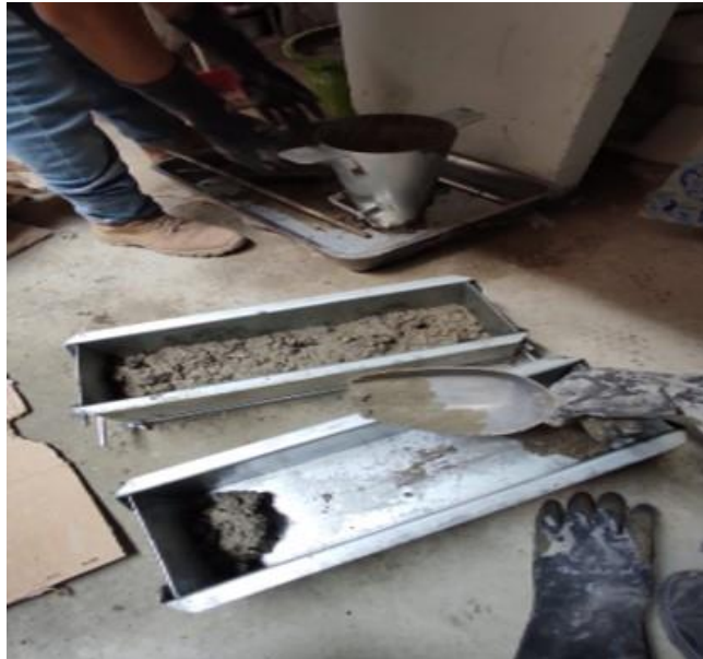
Figura 27. Proceso de llenado de los moldes de tipo viga.
