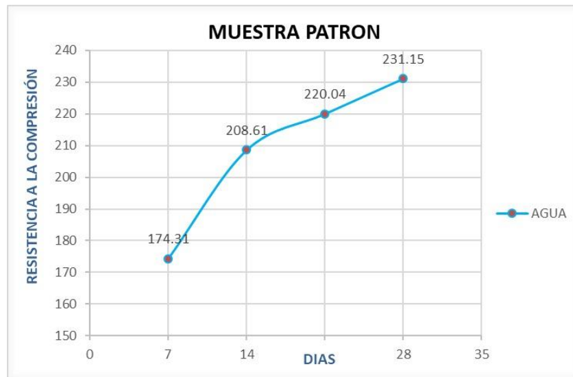
Figura 3. Curva del concreto curado con agua
