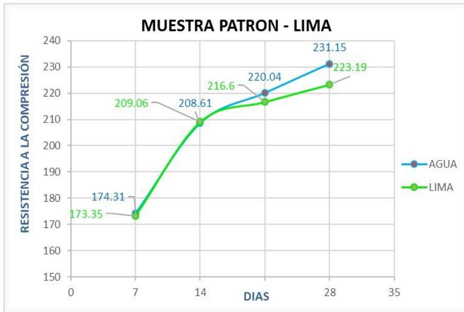
Figura 8. Curva del concreto curado lima vs agua
