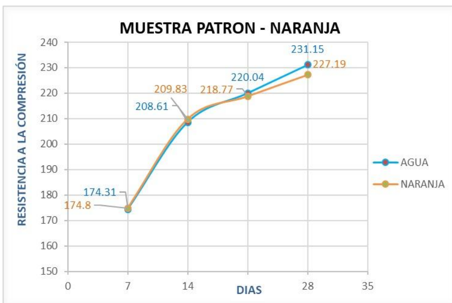
Figura 7. Curva del concreto curado con naranja vs agua
