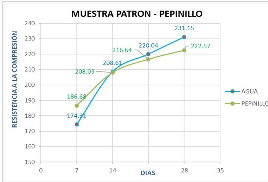
Figura 4. Curva del concreto curado con pepinillo vs agua
